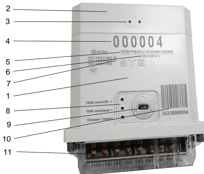
*Рисунок 6.1. Внешний вид сплит-счетчика РТМ-03(С2).*
