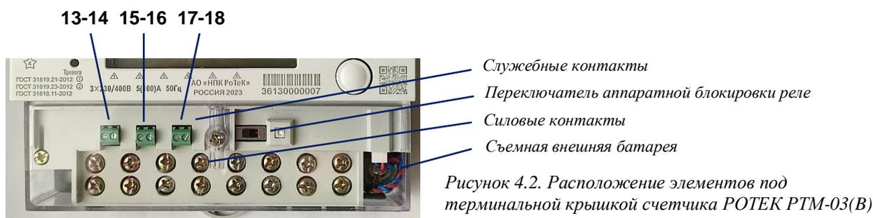
**Переключатель режимов блокировки реле размещен под терминальной крышкой и защищен пломбами (физической и электронной) от несанкционированного доступа.**
