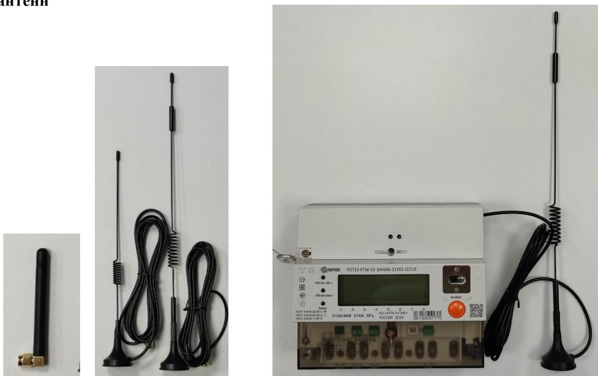
а) Внутренняя антенна б) Внешние антенны в) ПУ РТМ-03(В) с внешней антенной.
