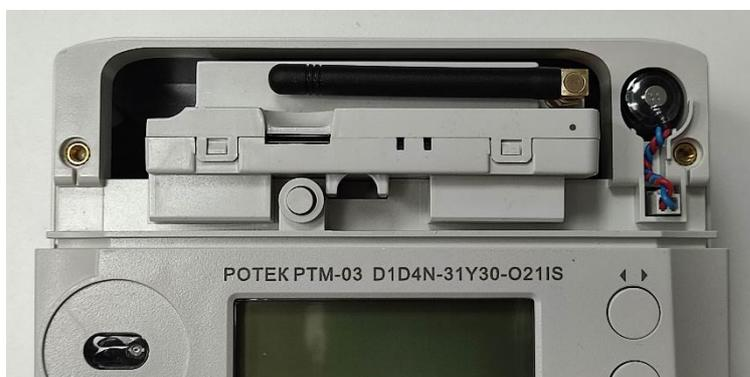
б) Модуль, установленный в ПУ
