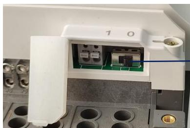
Переключатель блокировки реле нагрузки
