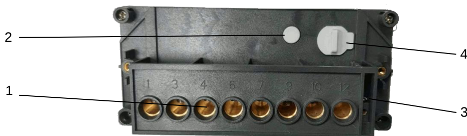
Рисунок 6.2. Расположение выводов и контактов счетчика РТМ-03(С2) в сплит-исполнении.
