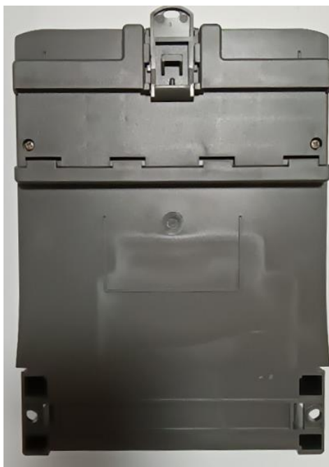
Рисунок 7.4. Счетчик РОТЕК РТМ-03(Д1) с адаптером на DIN-рейку.
