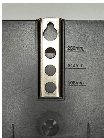
Рисунок 7.2. Положения крепления счетчика РОТЕК РТМ-03(Д1) в верхней точке
