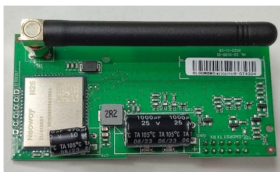
в) Плата модуля с разъемом SMA и внутренней антенной
