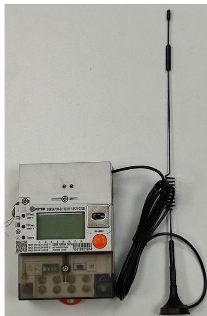
а) Внутренняя антенна б) Внешние антенны в) ПУ РТМ-01(В1) с внешней антенной.
