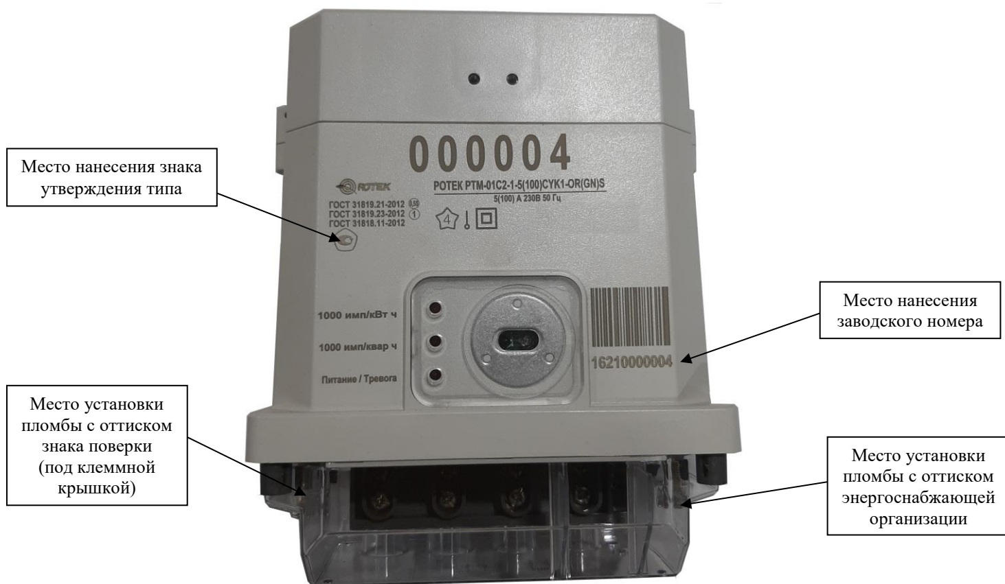
Рисунок 5 – Общий счетчиков для установки на опору (тип 2) с указанием места ограничения доступа к местам настройки (регулировки), места нанесения знака утверждения типа, места нанесения заводского номера
