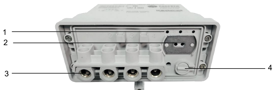
Рисунок 5.2 Расположение выводов и контактов счетчика РТМ-01 в сплит-исполнении.
