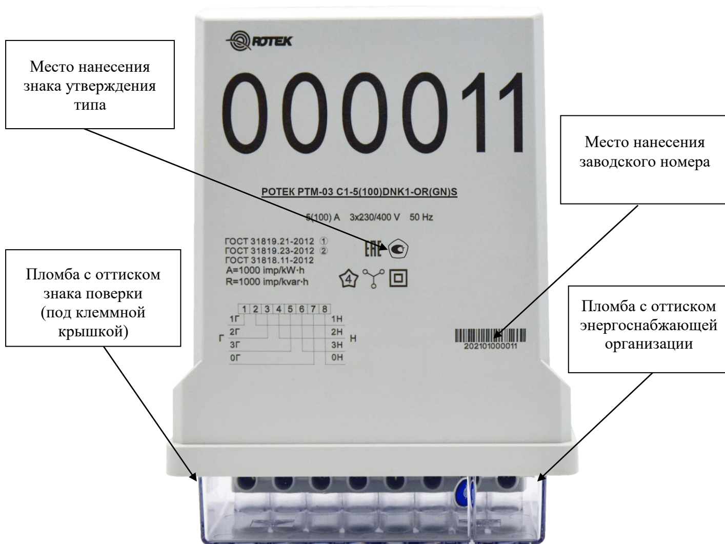
Рисунок 4 – Общий вид счетчиков для установки на опору с указанием места ограничения доступа к местам настройки (регулировки), места нанесения знака утверждения типа, места нанесения заводского номера
